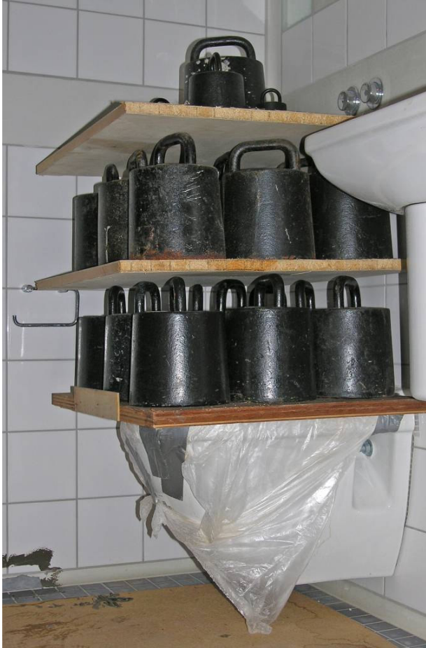
29. Belastning af toilet med lodder.
