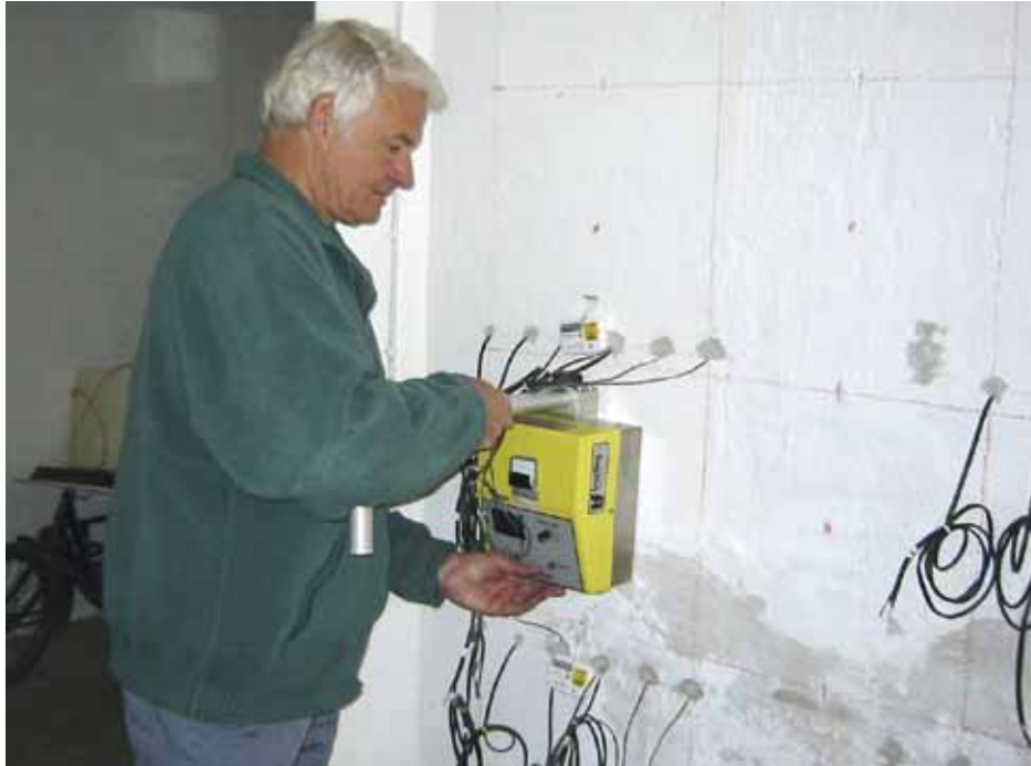
Fugtmåling med Troxler metoden (neutronkilde)
