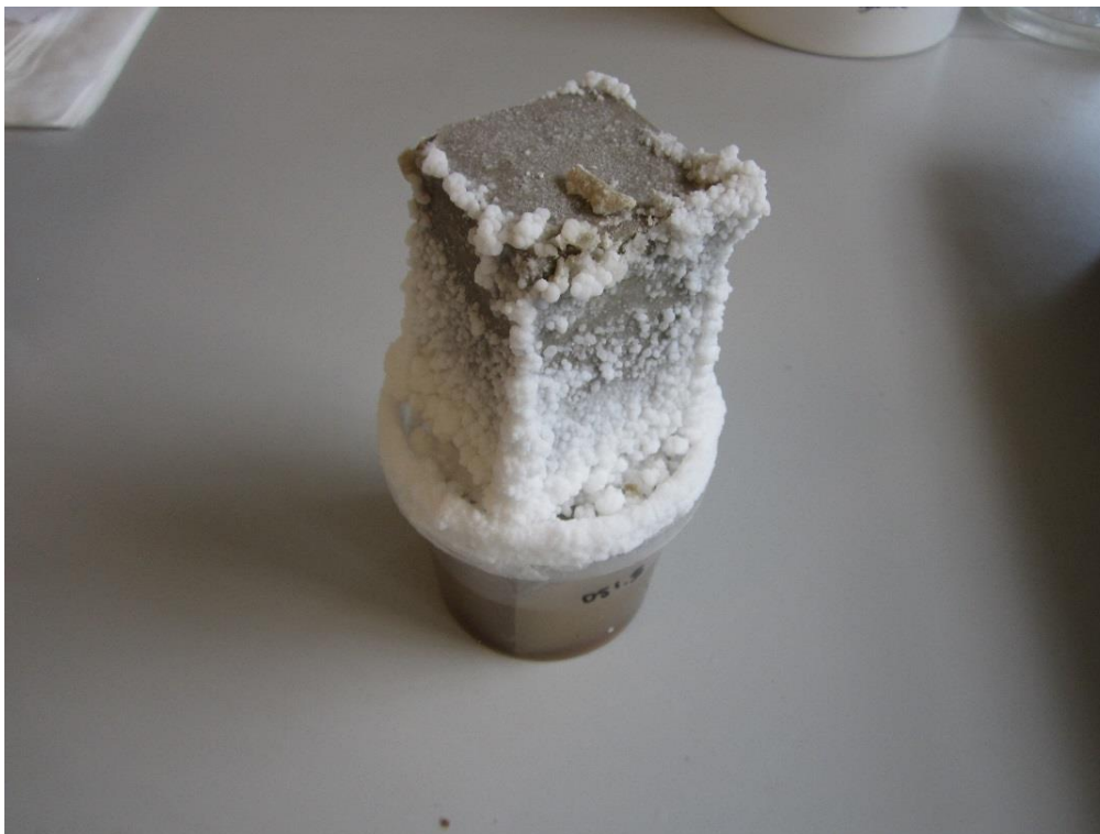
Foto 5. Nedbrydning af sandsten ved opsugning af opløsning med natriumformiat i test B.
