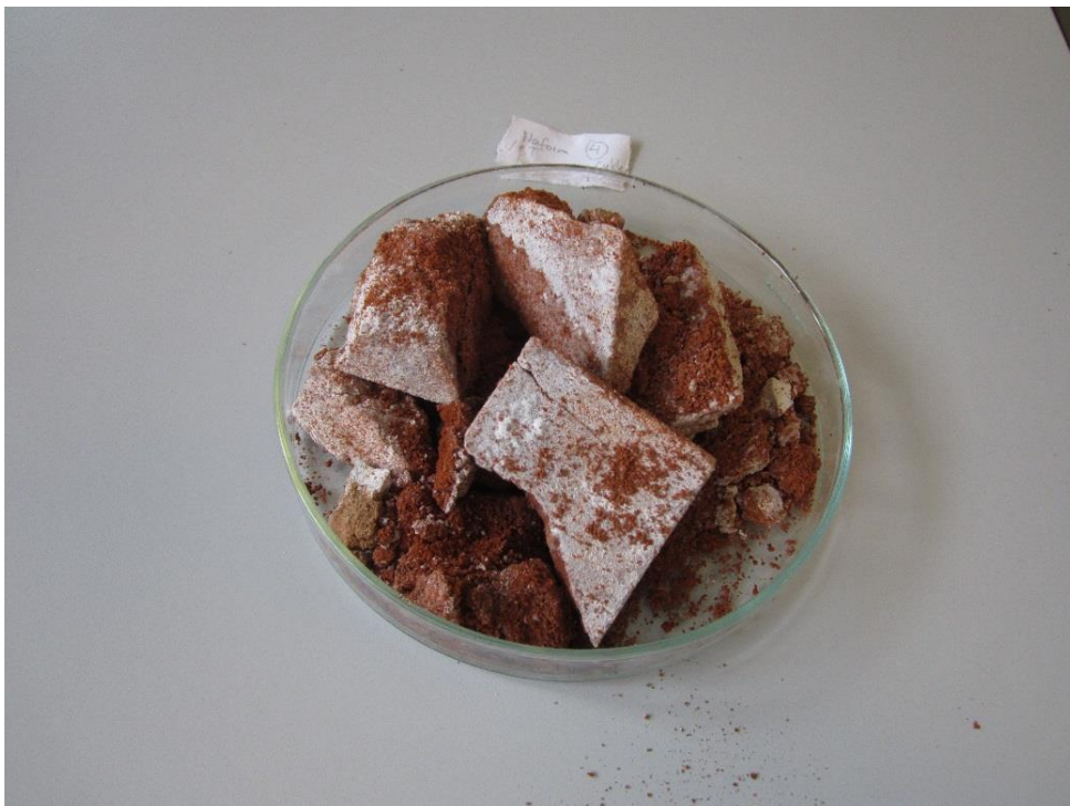
Foto 7. Nedbrydning af rød tegl mættet med natriumformiat ved varierende temperatur i test D
