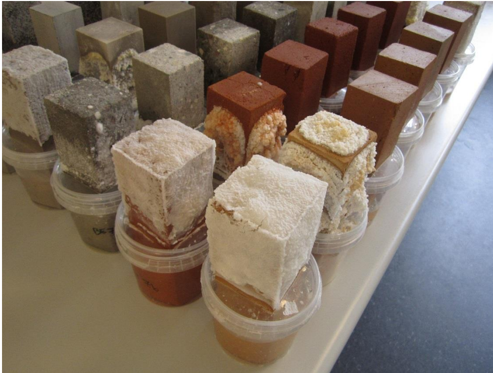
Foto 2. Prøver i bægre med saltopløsning i test B (opsugning)
