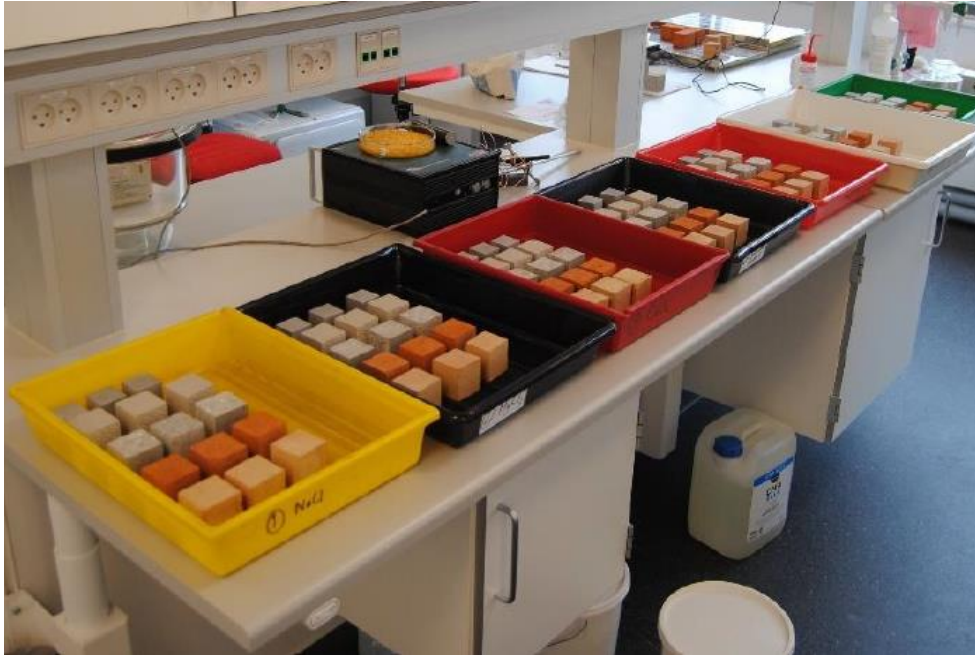
Foto 1. Prøver i bakker med saltopløsning i test A (opfugtning/udtørring)
