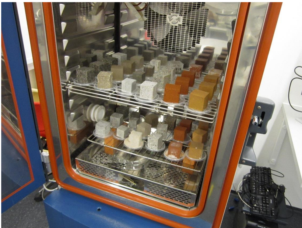
Foto 3. Prøver i klimaskab i test C (varierende luftfugtighed)
