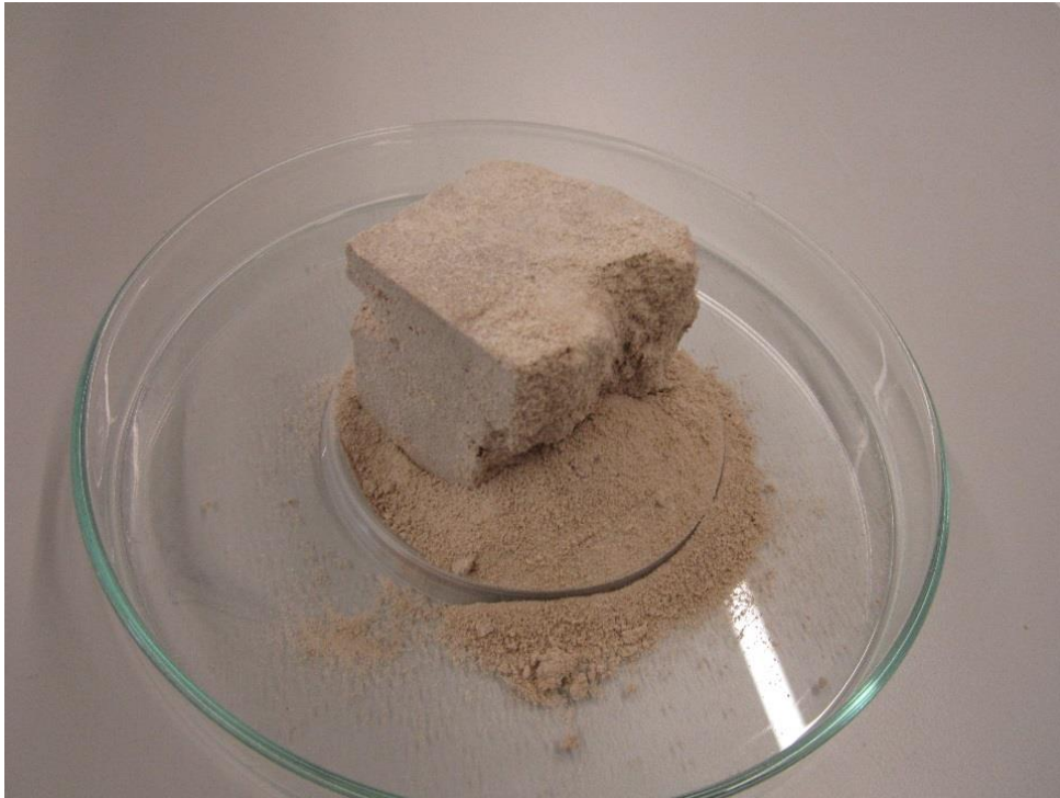
Foto 6. Nedbrydning af sandsten mættet med urea ved varierende relativ luftfugtighed i test C
