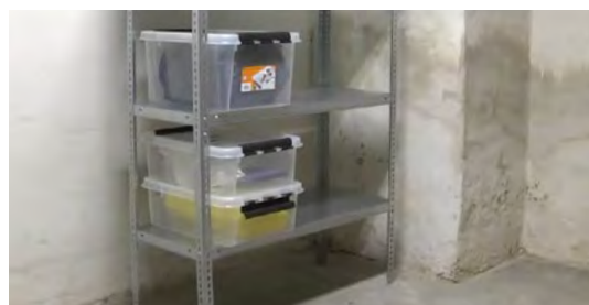
Den bedste måde at opbevare indbo i kælderen. Rustbeskyttet stålreol stillet mindst 10 cm fra væg og nederste hylde 40 cm over gulv.
